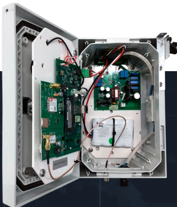
Particolare interno di un concentratore MPX 2
